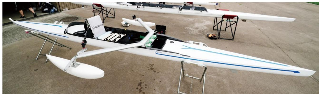
安全のためリガーにポンツーンが取り付けられています。シートは背もたれ付きで、スライドせず固定されています。
