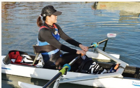
シートの高さがやオールを取り付ける位置が1cm変わっただけでも漕ぎ方に影響が出ます
