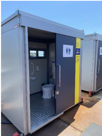
写真-17 仮設トイレ
