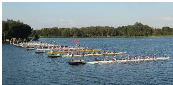
垂下式ステックポート。二本のポートに7段製と思われる枠を乗せ全体をスチールパイプでぶら下げている
