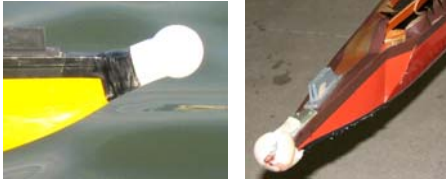
パウ・ボール(左) 衝突で破損し負傷事故となった事例(右)
