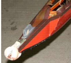
中・右:衝突によるバウ・ボールの損傷・突出し事例
