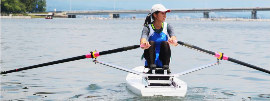
サーフボードのような平らな船体に、ローイングユニットを取り付けたロウボード
