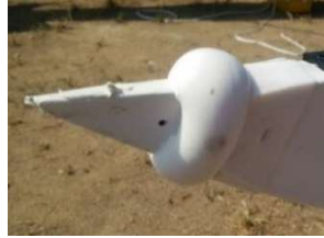
中・右:衝突によるバウ・ボールの損傷・突出し事例
