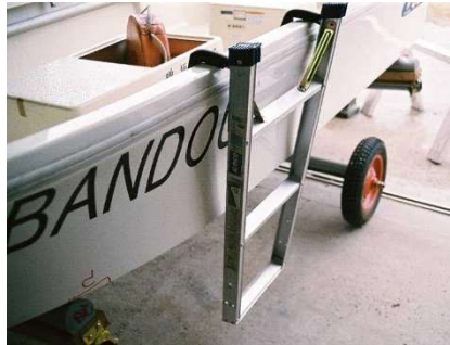
脚立を利用して自作した救助用ステップの事例
