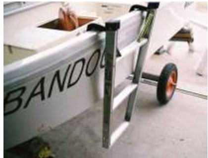
脚立を利用して自作した救助用ステップの事例
