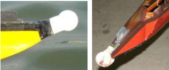
左:パウ・ボール 右:衝突で破損し負傷事故となった事例(劣化しもろくなっていた)
