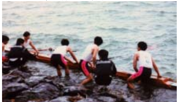
浸水した艇はそのまま持ち上げてはいけない。
